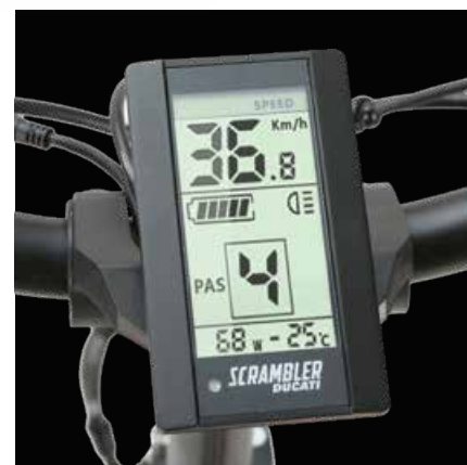
Display con sensore crepuscolare e di temperatura
