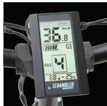
Display con sensore crepuscolare e di temperatura
