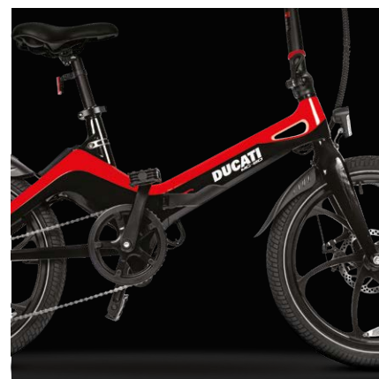
Telaio, forcella e cerchi in magnesio
