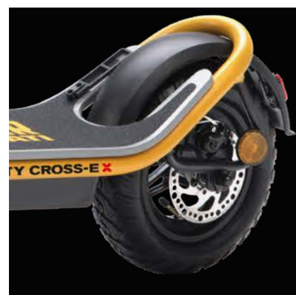
Freno a disco posteriore
